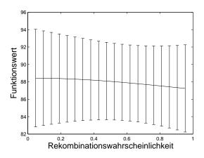
Abbildung 4.4: Funktionswert Y in Abhängigkeit von den angepassten Parametern Populationsgröße, Mutationswahrscheinlichkeit und Rekombinationswahrscheinlichkeit. Auch hier liegt das Design mit 14 Designpunkten, für die jeweils zehn Generationen mit je zwei verschiedenen Random-Seeds berechnet werden, zugrunde. Der Funktionswert für die Fitnessfunktion  $\Psi_2$  zeigt sich kaum von der Rekombinationswahrscheinlichkeit beeinflusst.
