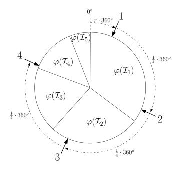
Abbildung 2.4: Beispiel für das stochastische universelle Sampling mit k=4. Die Nachfolgepopulation besteht aus den Individuen  $\mathcal{I}_1$ ,  $\mathcal{I}_1$ ,  $\mathcal{I}_2$  und  $\mathcal{I}_4$ . Das Individuum  $\mathcal{I}_1$  wird dabei zweimal selektiert und ist demzufolge in der Nachfolgegeneration zweimal enthalten.
