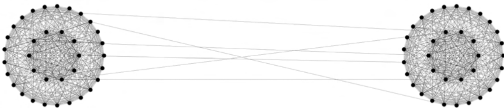
(d) Anwendung des Ausdünnungsalgorithmus auf den vollständigen Graphen mit Parameter \varepsilon = 100 : |S| = 70 , |E| = 950 , \Delta(G) \approx 1.248
